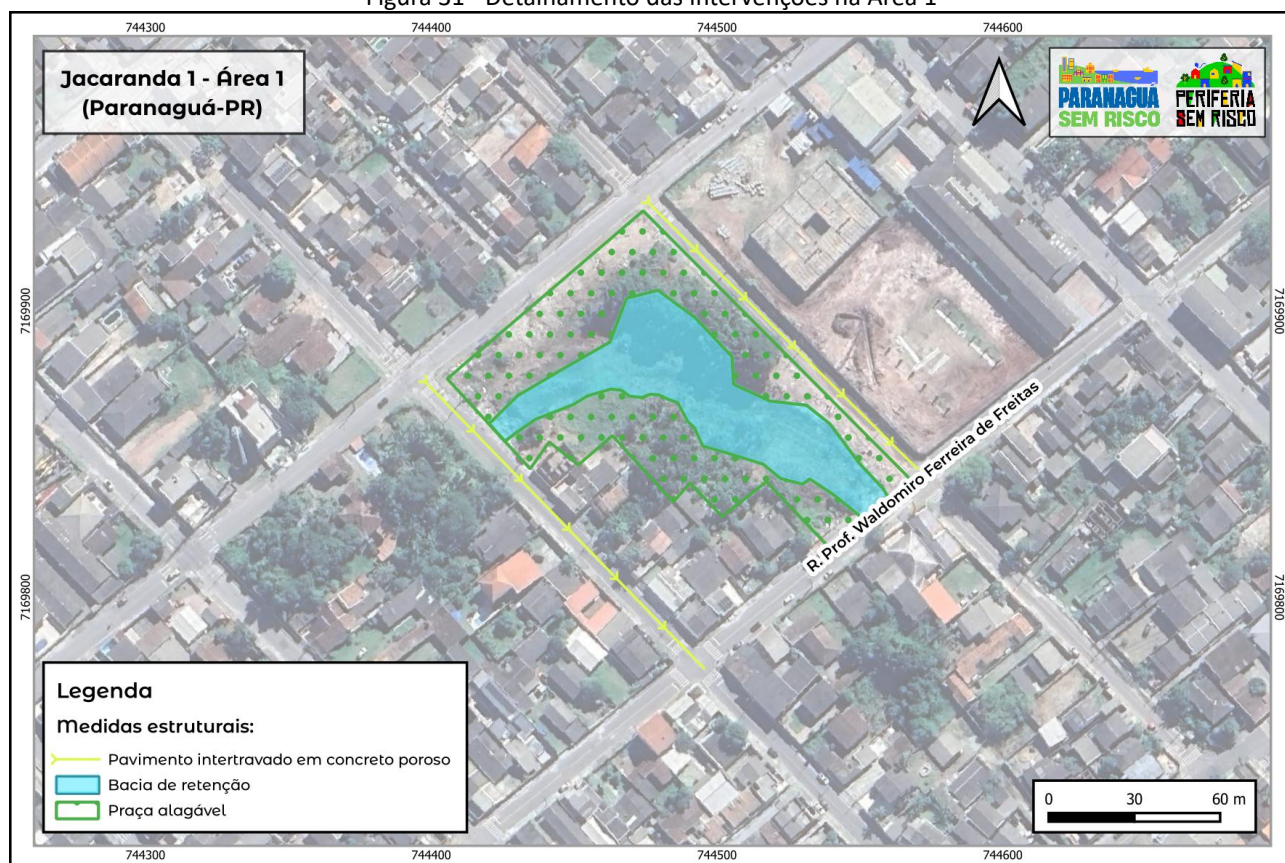
Figura 31 - Detalhamento das intervenções na Área 1
