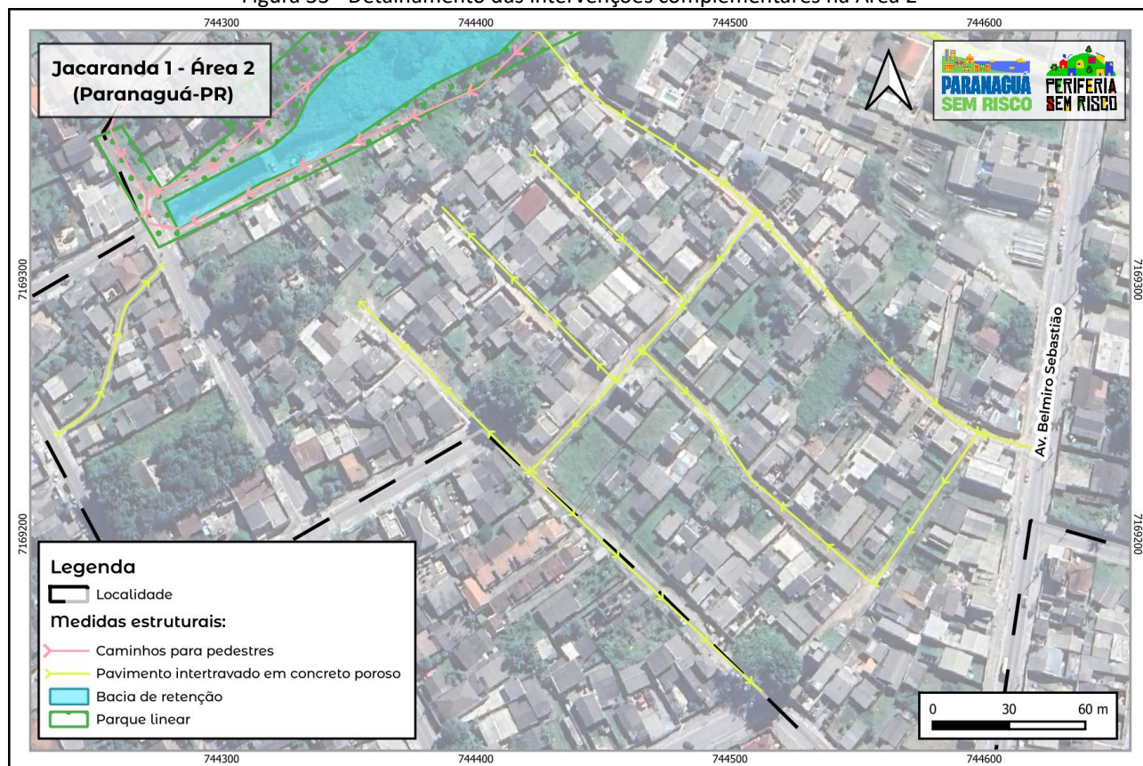
Figura 33 - Detalhamento das intervenções complementares na Área 2
