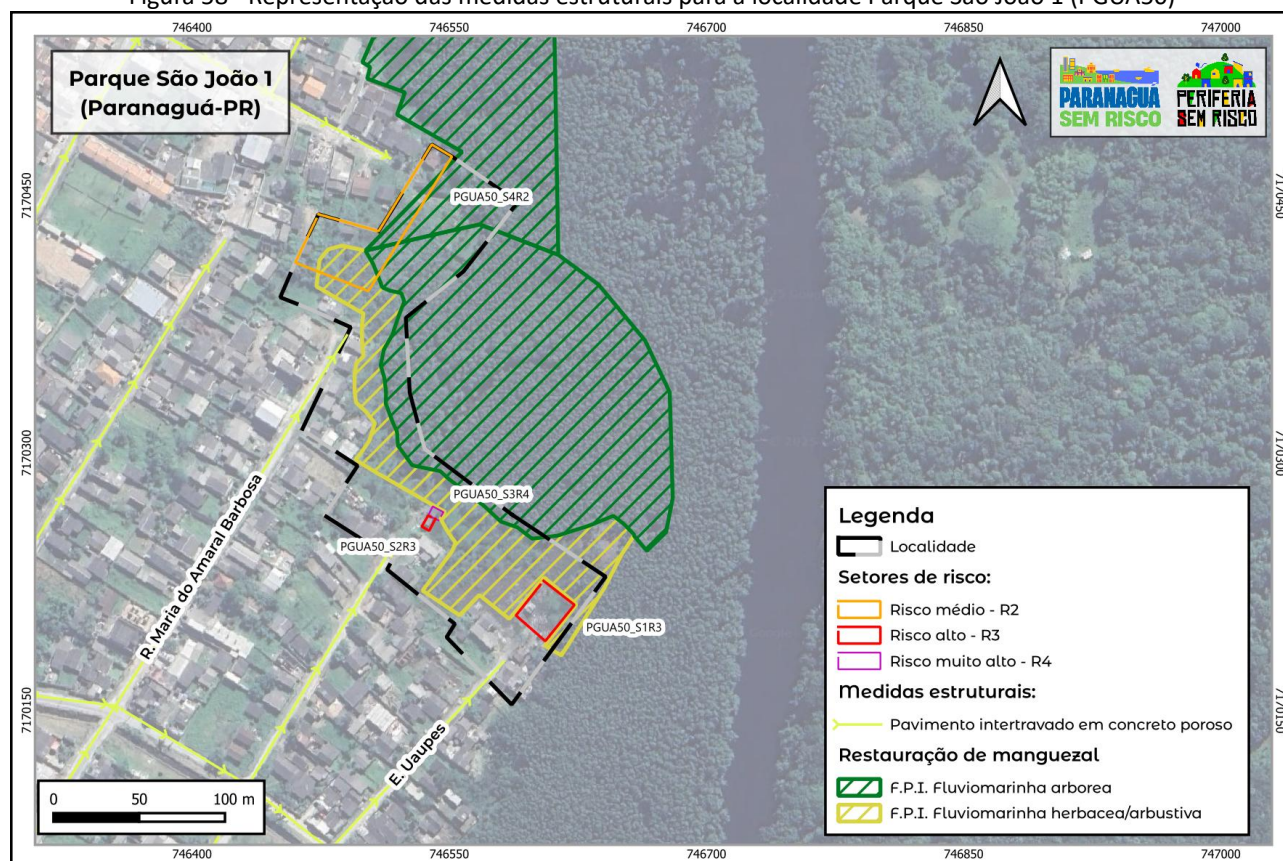
Figura 58 - Representação das medidas estruturais para a localidade Parque São João 1 (PGUA50)
