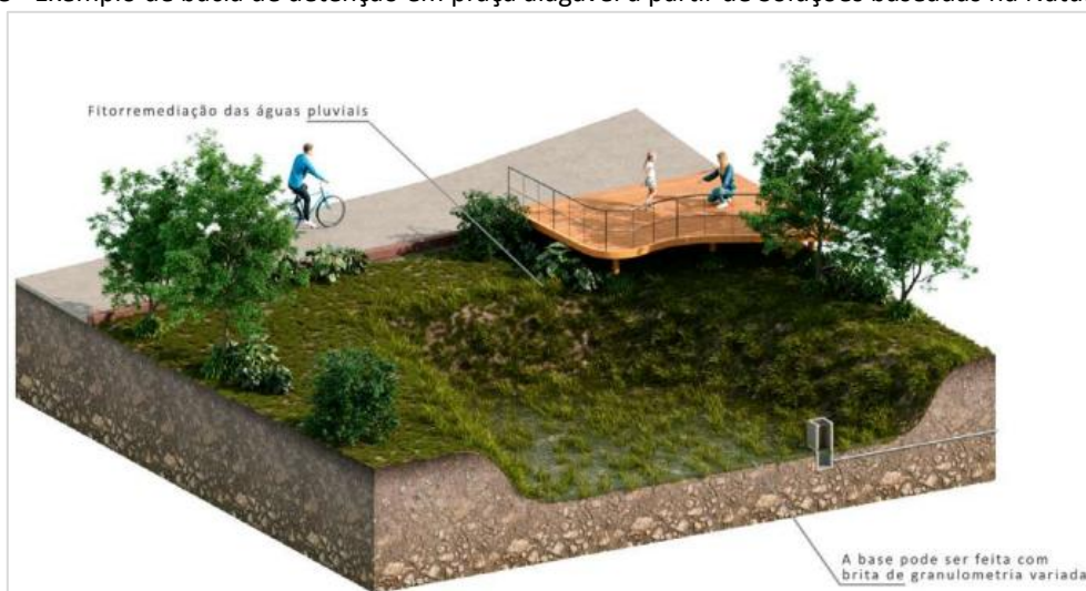
Figura 28 - Exemplo de bacia de retenção em praça alagável a partir de Soluções baseadas na Natureza (SbN)
