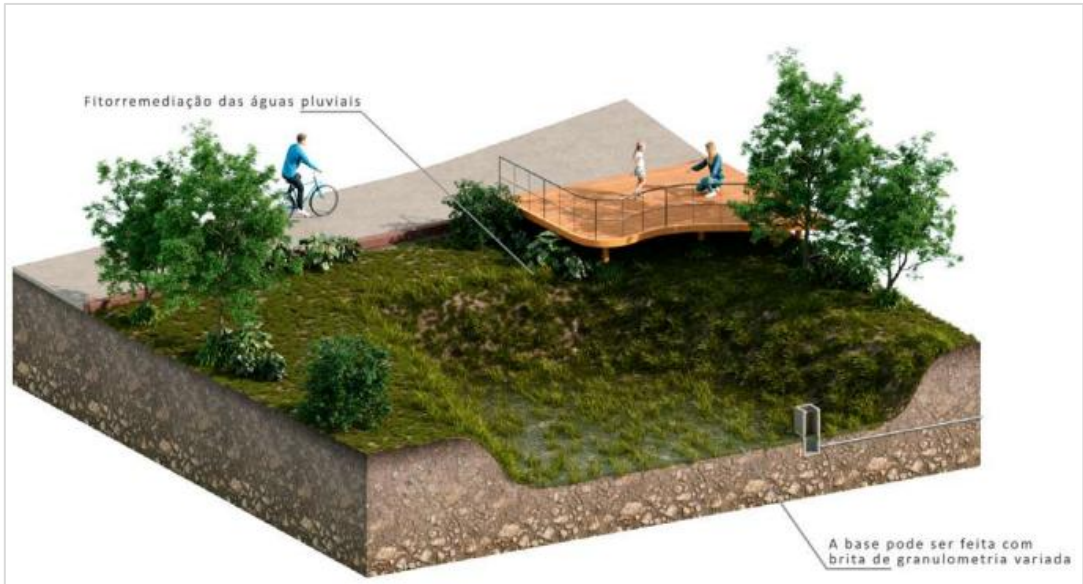
Figura 11 - Exemplo de bacia de detenção em praça alagável a partir de Soluções baseadas na Natureza (SbN)
