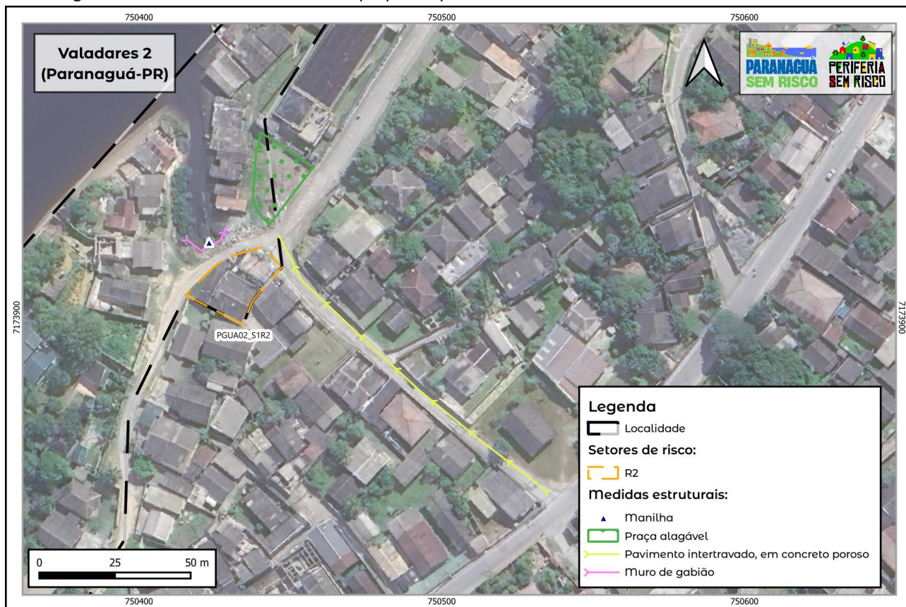
Figura 13 - Detalhamento das medidas propostas para a desembocadura do canal na localidade PGUA02
