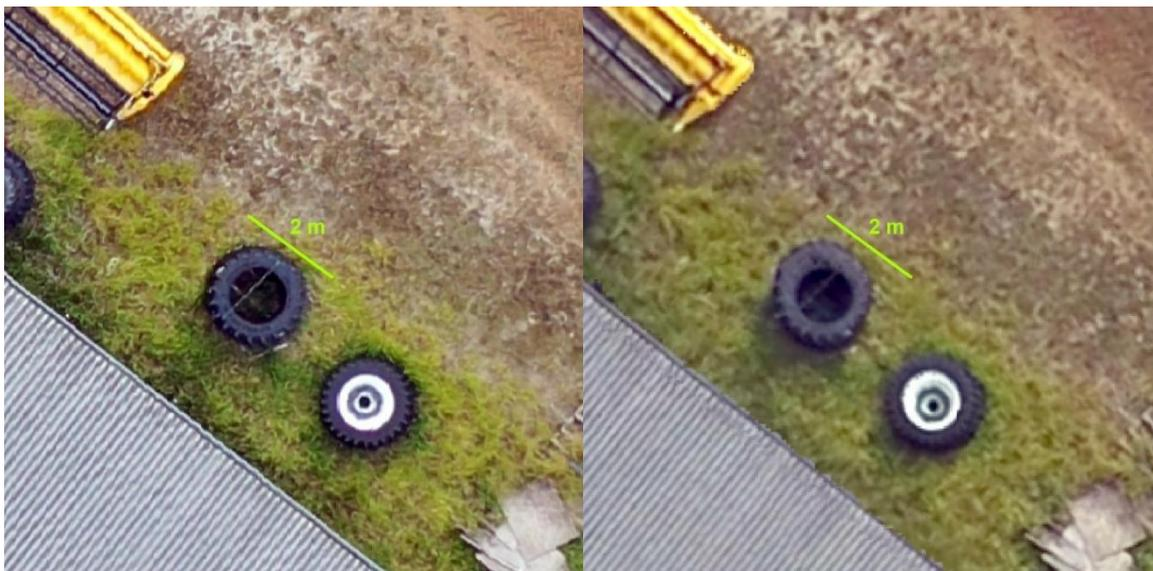
Figura 6 – Comparação da resolução espacial dos ortomosaicos gerados. Esquerda: Mavic 2 Pro. Direita: Phantom 4 Standard.
