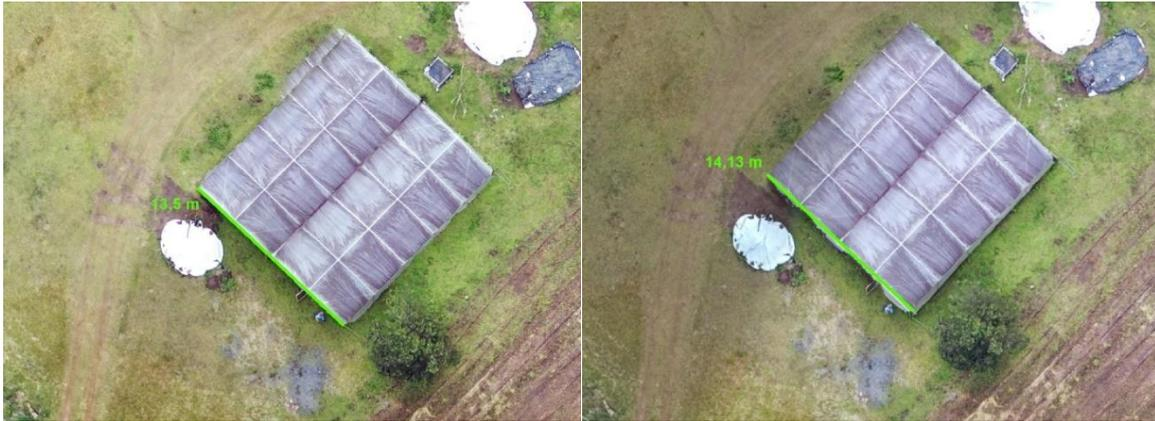
Figura 12 – Problema de distorção no ortomosaico híbrido. Esquerda: Mavic 2 Pro – 13,5m. Direita: Mavic+Phantom – 14,13 m.
