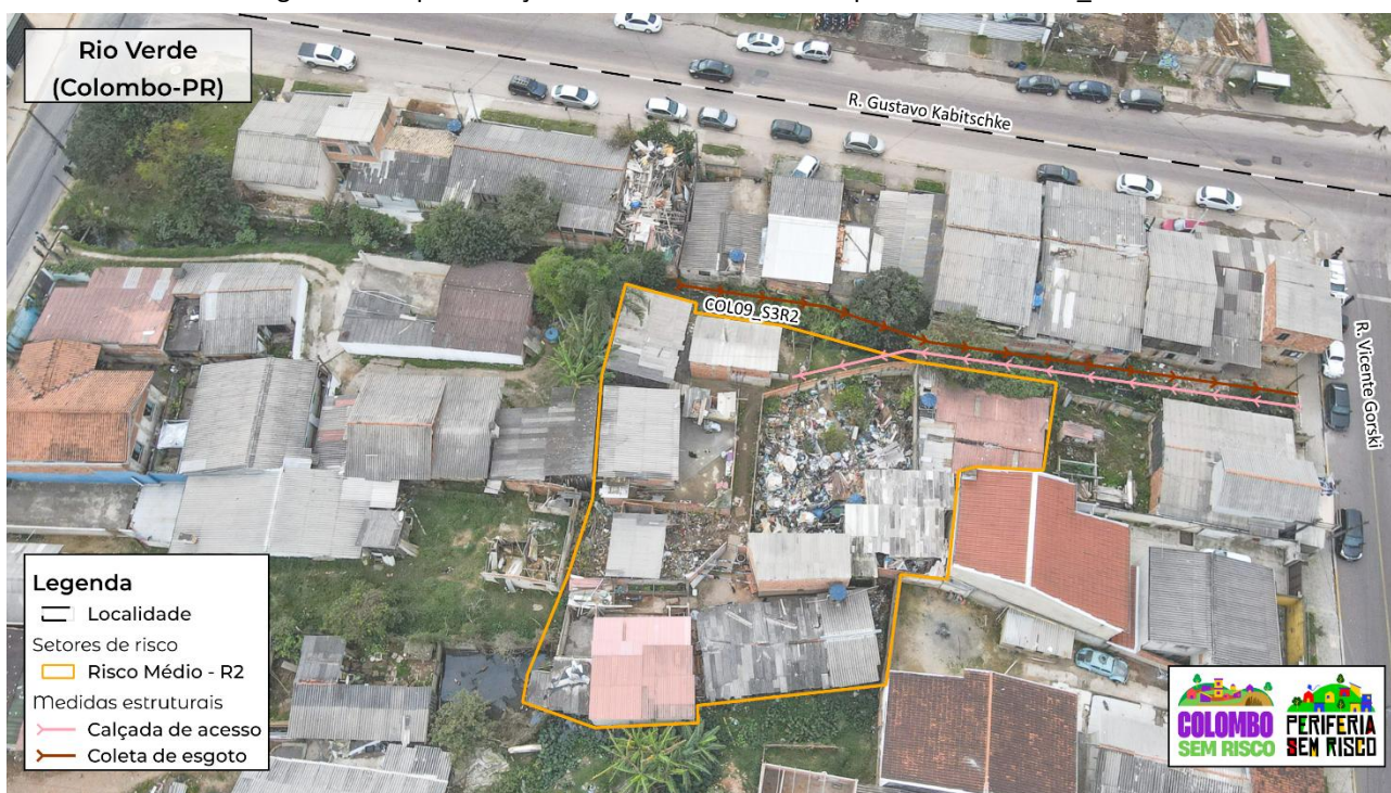
Figura 21 - Representação das medidas estruturais para o setor COL09_S3R2
