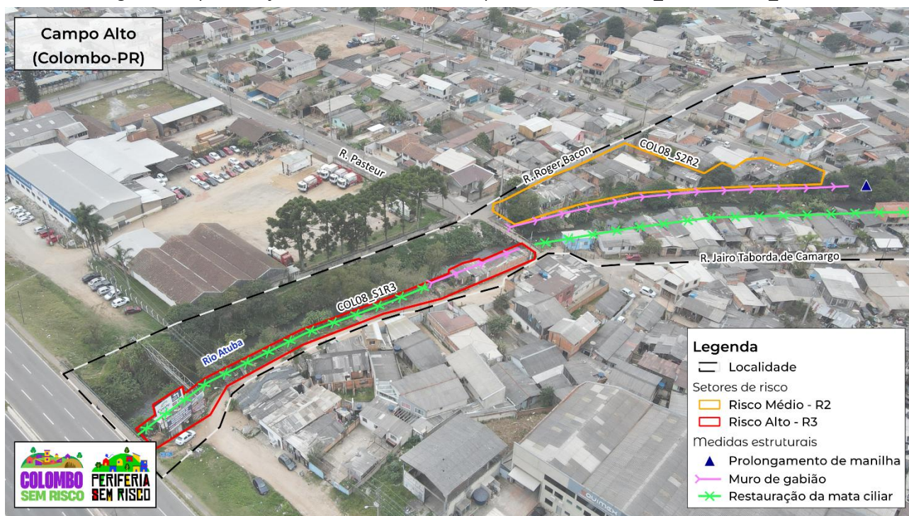
Figura 9 - Representação das medidas estruturais para os setores COL08_S1R3 e COL08_S2R2
