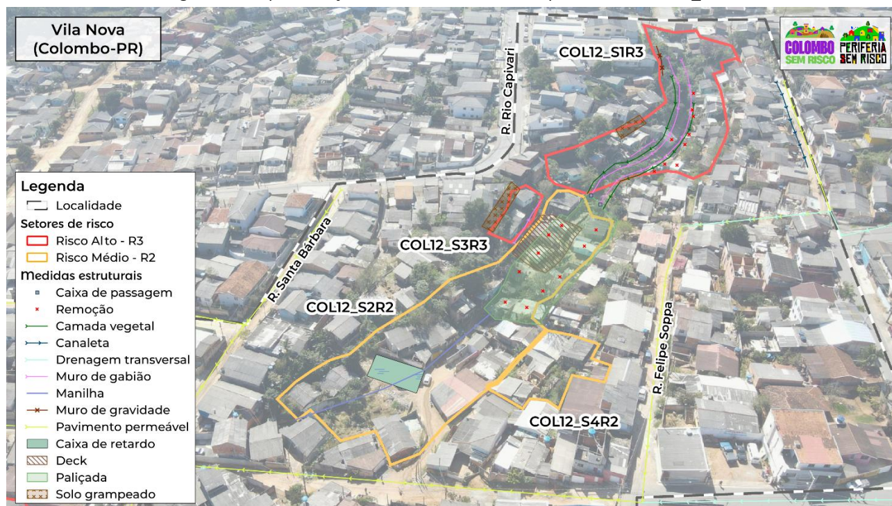
Figura 29 - Representação das medidas estruturais para o setor COL12_S2R2
