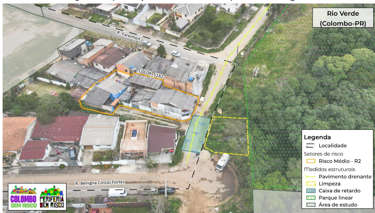
Figura 17 - Representação das medidas estruturais para o setor COL09_S1R2
