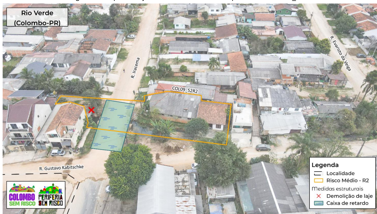
Figura 19 - Representação das medidas estruturais para o setor COL09_S2R2
