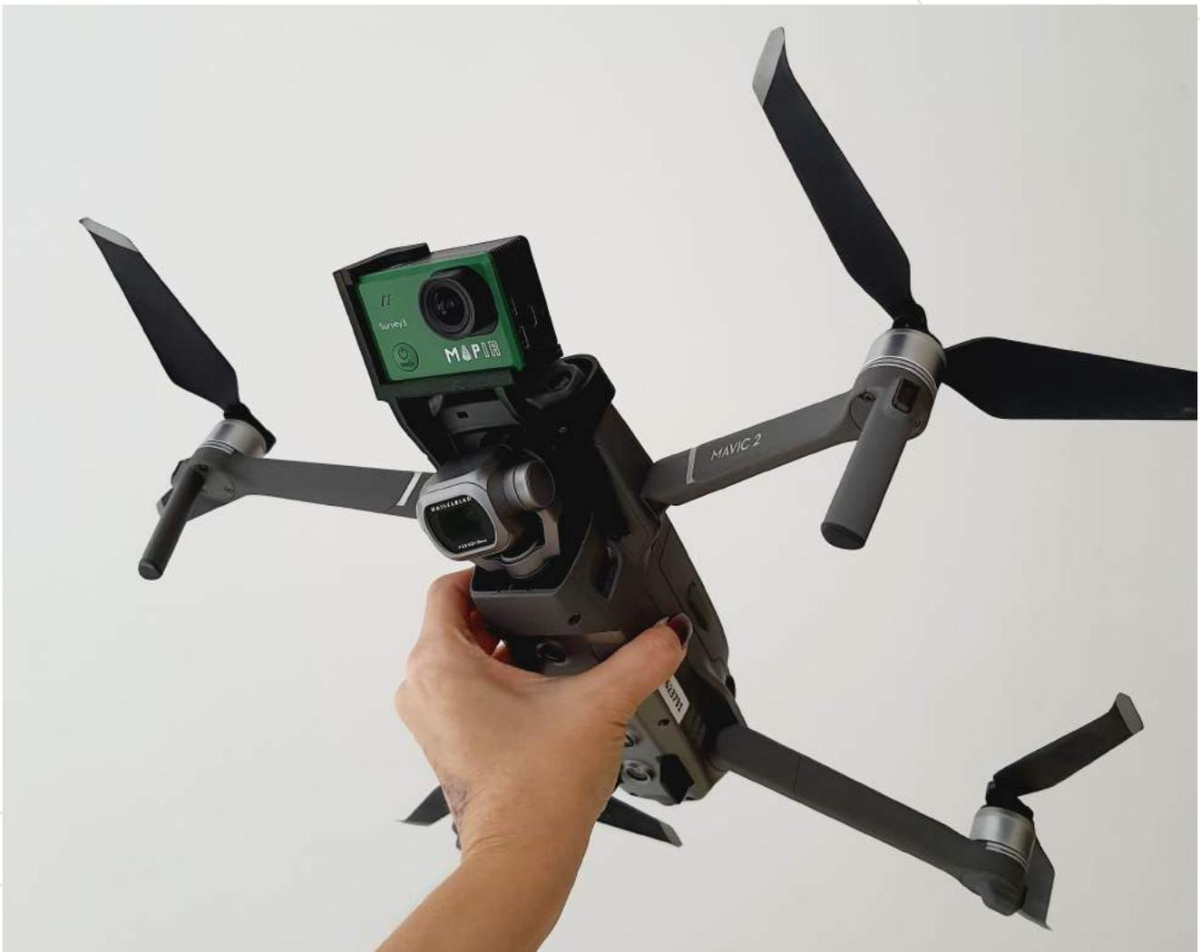
*Figura 7: Aeronave Remotamente Pilotada (ARP, popular "drone") utilizado para levantamento dos dados do estudo com sensor Mapir OCN Survey 3 acoplado, para levantamento de dados no comprimento de onda infravermelho, que possibilita análise de índices de vegetação.*
